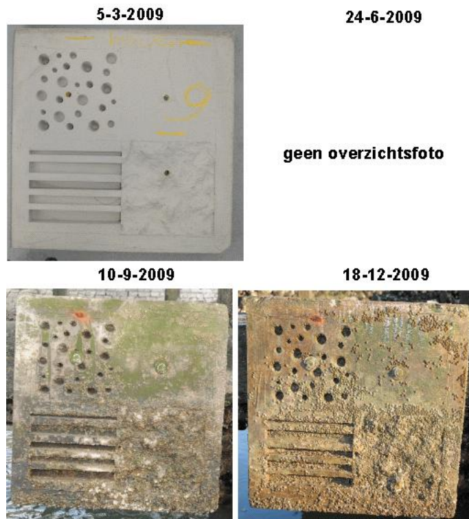
Figuur 3.9 De begroeiing van de ecobetonplaten aan de achterzijde van de watersteiger in de Scheurhaven in de loop van 2009.
