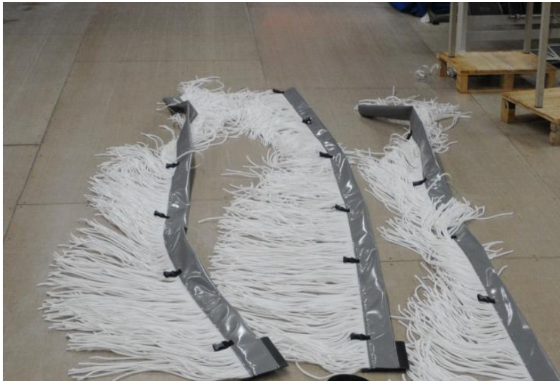
Figuur 2.2 Drie paalhula's voor de bevestiging
